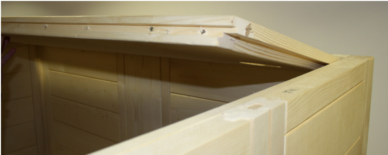
Fig. 18 : Insertion de l'élément de toit avant
