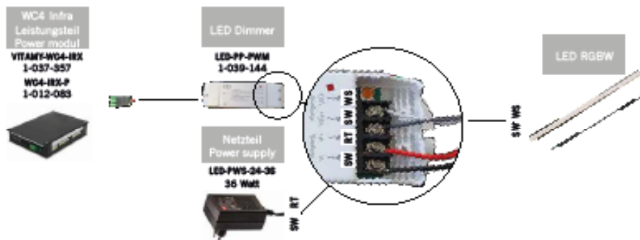
Fig. 43 : Raccordement de la RGBW LED à la commande
