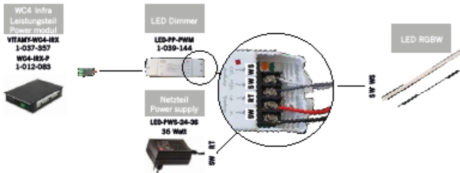
Fig. 44: Conexão da tira LED ao comando
