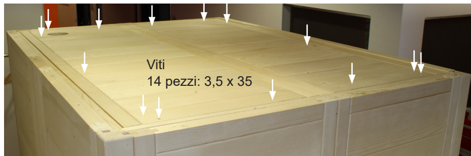
Fig. 19: Fissaggio degli elementi tetto
