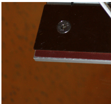
Fig. 23: Montaggio delle guarnizioni della porta 2
