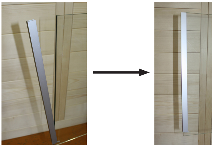
Fig. 11 : Montage des profilés en U sur les plaques en verre
