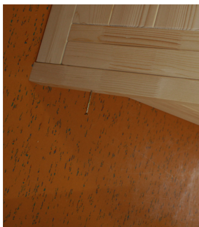
Fig. 47: Montaggio dei listelli distanziatori sul pannello posteriore
